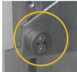
Rys. 58 Tuleja LB 18-2-SL13-2xM5x16.
